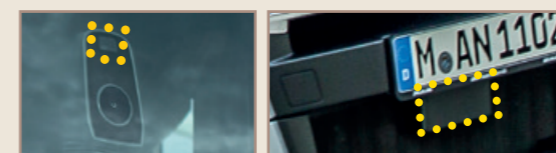
La cámara y el radar aseguran que el sistema no malinterprete los obstáculos no relevantes.
