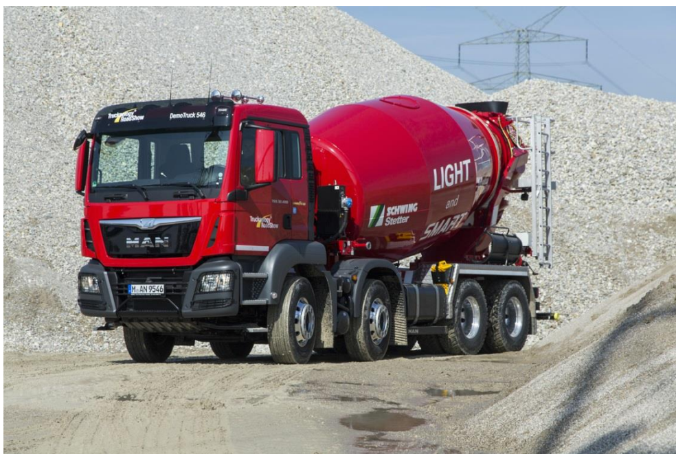
Um clássico da construção: MAN TGS 32.400 8x4 BB utilizado como betoneira
