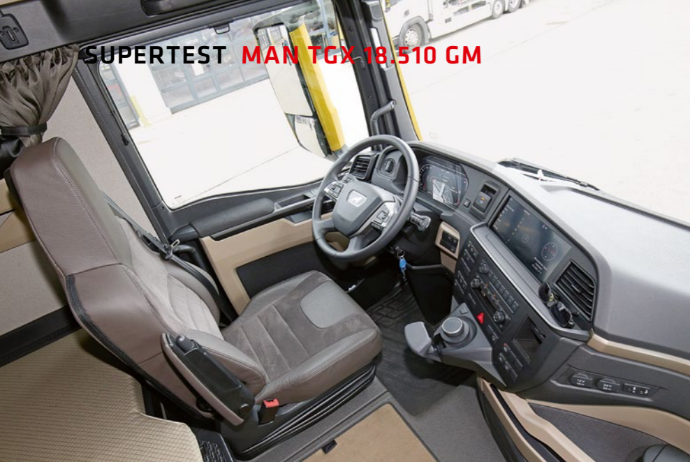
Top Lenkradverstellung, der Smart-Select-Button erlaubt eine sehr gute Bedienbarkeit
